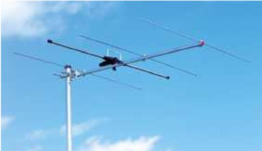
Antenne yagi en polarisation horizontale
